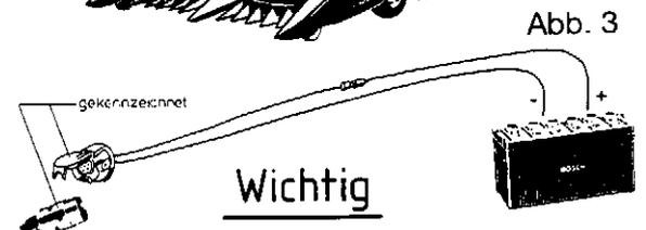
Um Spannungsabfall zu vermeiden, muß unbedingt die mitgelieferte 7-polige 12 V-Steckdose mit 4<sup>2</sup> Kabeln direkt an die Batterie angeschlossen werden.
