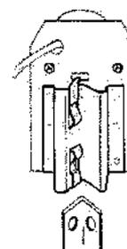
Verlustsichere, auswechselbare Arretierfeder gibt der Leuchteinheit sicheren Halt am Befestigungsprofil.
