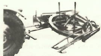
3 Rübenernter für Schlepperzug zur Ernte von Runkel- und Stoppelrüben
