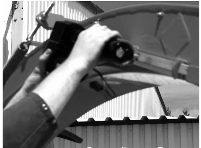
Kabel servomotora mora se položiti kroz kabelsku vodilicu.
