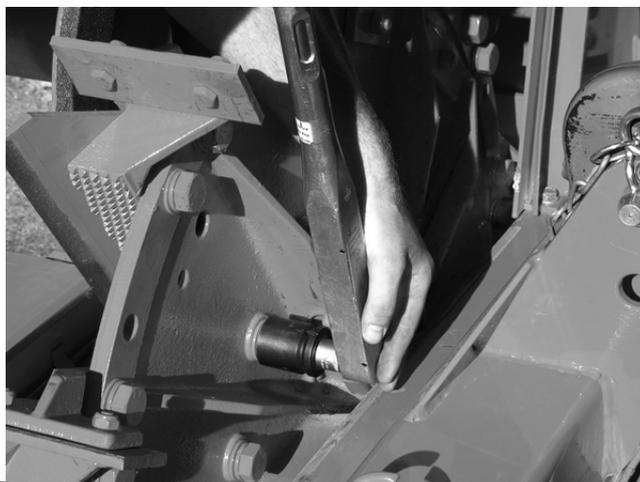
U potpunosti uklonite noževe s nosačem noževa.
