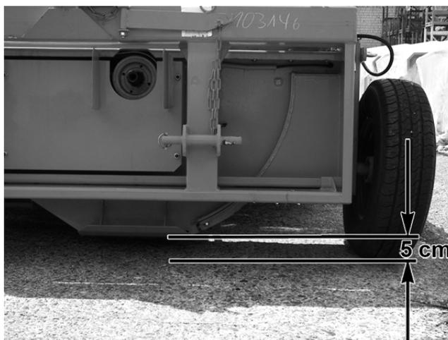
Agregat za usitnjavanje nakon osnovnog podešavanja više se ne podešava. Adapter se podiže odn. spušta pomoću cilindra adaptera.
