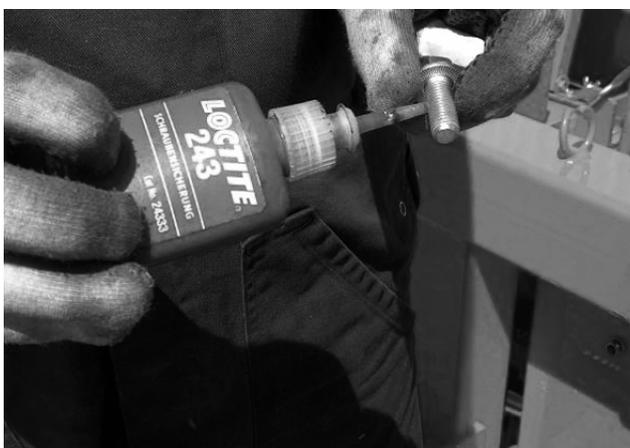
Vijak pričvrstite uz pritezni moment od 190 Nm. Na kraju, obrnutim redosljedom montirajte zaštitu zglobnog vratila.
