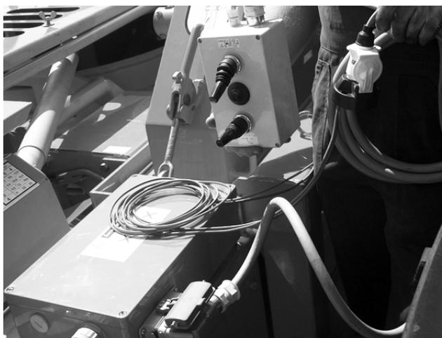
Način reagiranja detektora metala može se podesiti. U tu svrhu okrećite potencijometar (A) u upravljačkoj kutiji.
