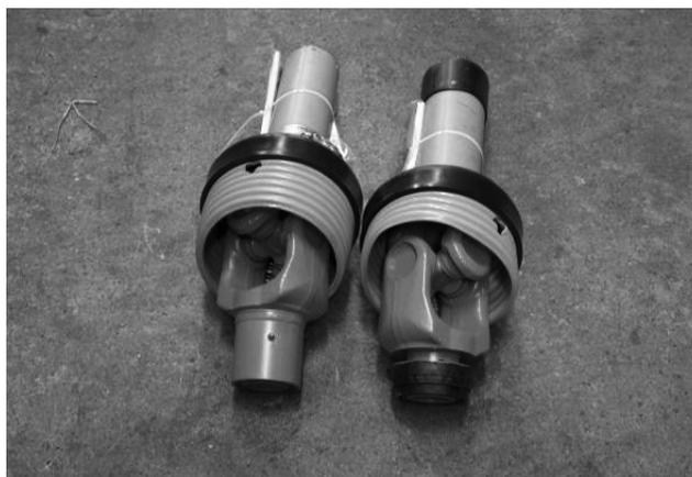
Duljinu zglobnog vratila potrebno je prilagoditi odnosnom priključnom uređaju (adapteru). Potrebno je pobrinuti se za pravilno prekrivanje obje polovice zglobnog vratila (minimalno 150 mm).
