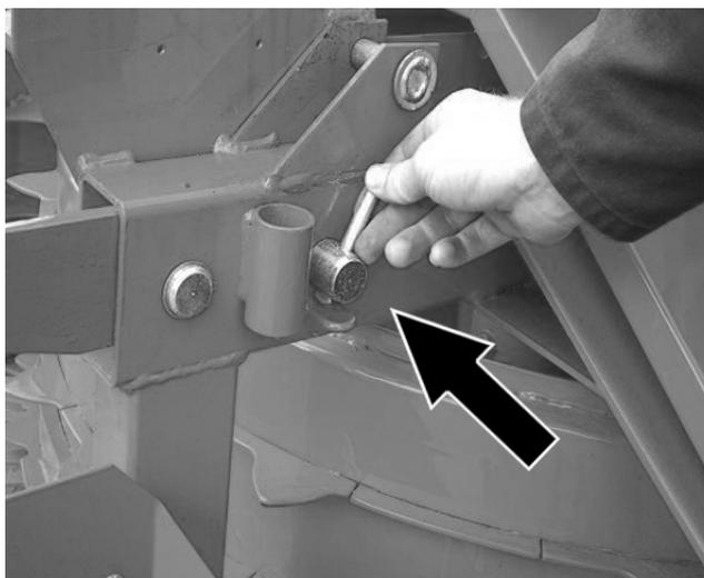
Adapter za žetvu kukuruza sada je viseći obješen. Pomoću opruga u priključnom okviru adapter za žetvu može se bolje prilagoditi tlu.
