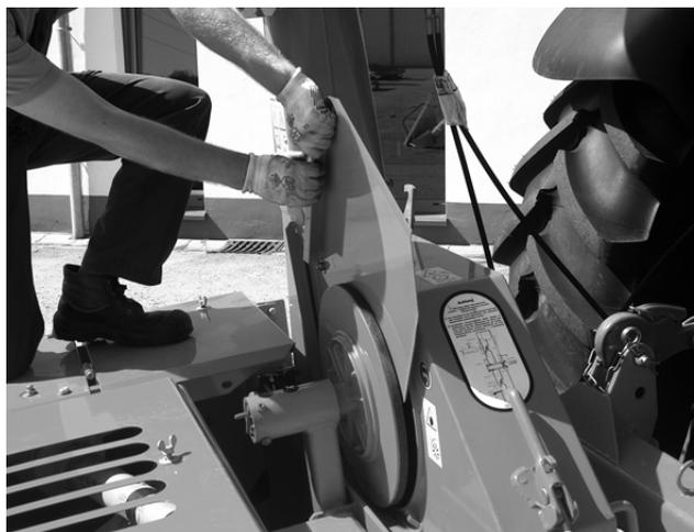
Otpustite kontramaticu uređaja za brušenje.
