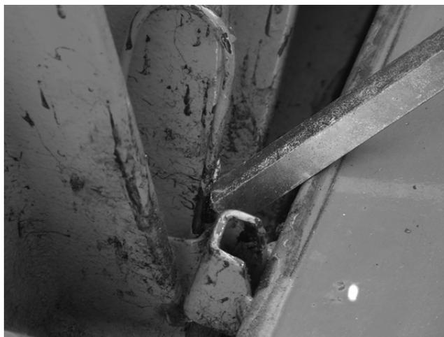
Isporučenu polugu za montažu od 16 mm uglavite u četverokutni otvor matice.
