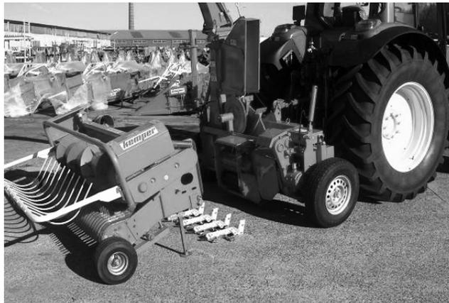
Otpustite ručicu, potpornu nogu s lijeva i s desna gurnite prema gore dok se poluga ne uglati.
