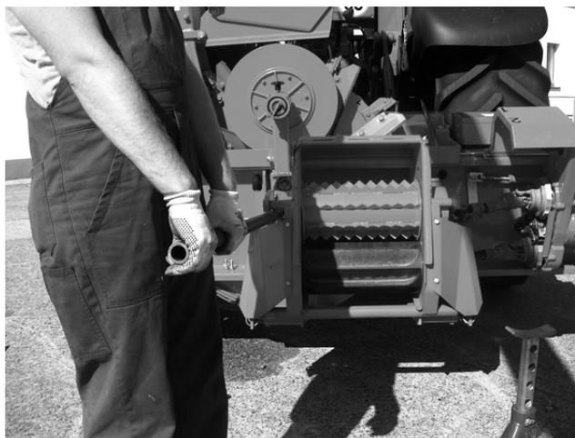
Zglobna vratila automatski se izvlače. Kod preklapanja prema dolje profilne cijevi cilindričnog kanala moraju se spojiti.
