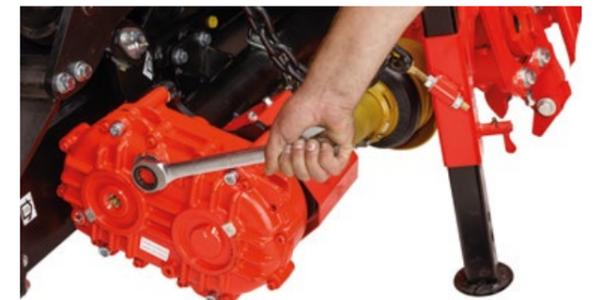
Grâce à la boîte de vitesses multi-vitesses avec quatre vitesses, la vitesse des têtes de récolte - avec ou sans entraînement variable - s'adapte parfaitement à n'importe quelle longueur de coupe.
