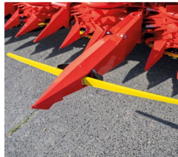
Les capteurs de direction situés à l'extrémité centrale indiquent la bonne direction pour les têtes de récolte.
