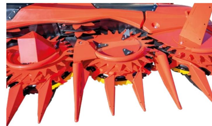
Grâce à sa conception plate, le maïs versé est soigneusement introduit sur les tambours du convoyeur et transporté en toute sécurité vers le broyeur. Les blocages sont réduits tout comme la nécessité d'inversion.
