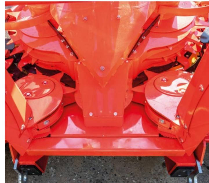
Les tambours de convoyage inclinés et la nouvelle table centrale de forme spéciale répartissent les plantes uniformément sur toute la largeur des composants de l'ensileuse. Rien ne passe à côté !
